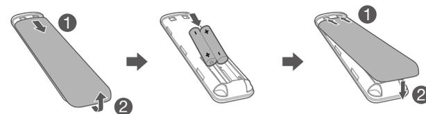
Faites glisser le couvercle du compartiment des piles en direction de la flèche jusqu'à son dégagement complet. Insérez 2 piles AAA (1,5 V) orientées en respectant leur polarité. Remettez le couvercle du compartiment des piles en place.
